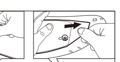
2 Jika lapisan koyak CWR-F2R tidak dipasang dengan cukup kuat, putar butang kiri dan kanan lawan jam (Lukisan 4) untuk meningkatkan tegangan lapisan dan kukuhkannya dengan betul pada pelindung/visor.
