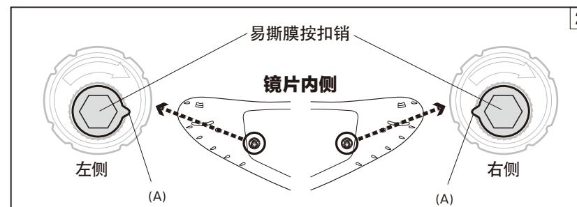
**使用PINLOCK® EVO lens时，请按照PINLOCK® EVO lens附带的使用说明书，调整易撕膜按扣销。此外，请先安装PINLOCK® EVO lens后，再安装易撕膜。**
