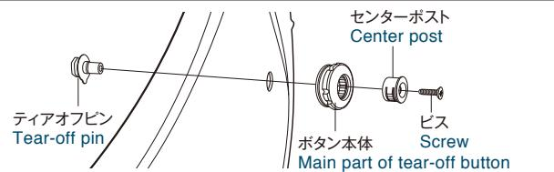
CWR-F2Rシールドに取り付けられているCWR-F2Rティアオフボタンのボタン本体を反時計回りに回し、図1のようにシールド正面から見てセンターポストが下に来るように調節します。ティアオフボタンを調節する際、図2のように、シールド内側のティアオフピンの(A)部分の突起が、シールドの中心に向いているか確認してください。もし、この突起がシールドの中心に向いていない場合、シールド内側から工具などでティアオフピンを回して正しい向きに調節します。再度ティアオフボタンの調整を行った後、シールドをヘルメットに装着します。
