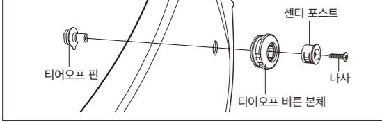
CWR-F2R 실드에 장착된 CWR-F2R 티어오프 버튼의 버튼 본체를 시계 반대 방향으로 돌려 그림1과 같이 실드 정면에서 봤을 때 센터 포스트가 아래로 오도록 조절합니다.
