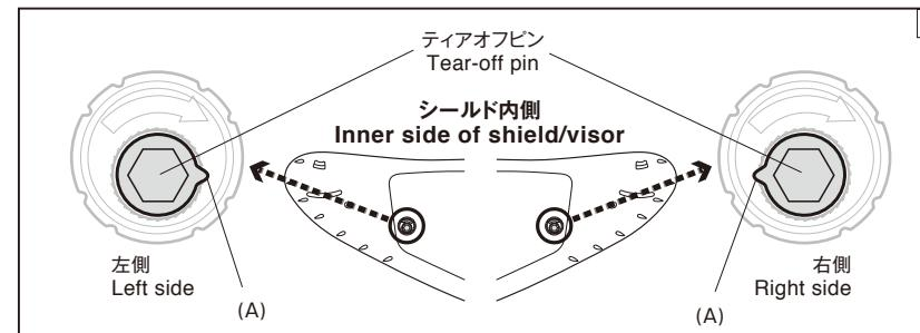
PINLOCK® EVO lensを使用する場合は、PINLOCK® EVO lensに同梱されている取扱説明書に従って、ティアオフピンの調整を行ってください。また、PINLOCK® EVO lensを先に装着してから、ティアオフフィルムを取り付けてください。
