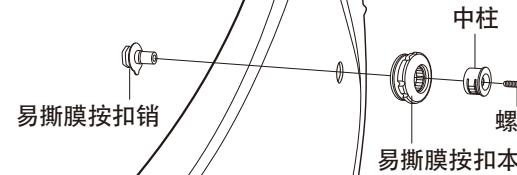
将安装着CWR-F2R镜片的CWR-F2R易撕膜按扣的按扣本体向逆时针方向旋转，进行调节，如图1所示，使中柱从镜片正面看时处于下方。
